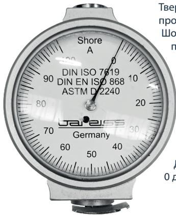
Твердость ролика определяет устойчивость резинового покрытия к вдавливанию, что влияет на его производительность в различных областях применения. Измерение твердости проводится по шкале твердости Шора А, где шкала Шора А является наиболее распространенной шкалой для измерения твердости для резиновых и полиуретановых материалов. Чем выше значение Шора А, тем тверже материал.
